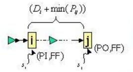
$$s_i + (D_i + \min(P_{ij})) - T_{hold} \ge s_j \quad \forall P_{ij} \in PS$$
